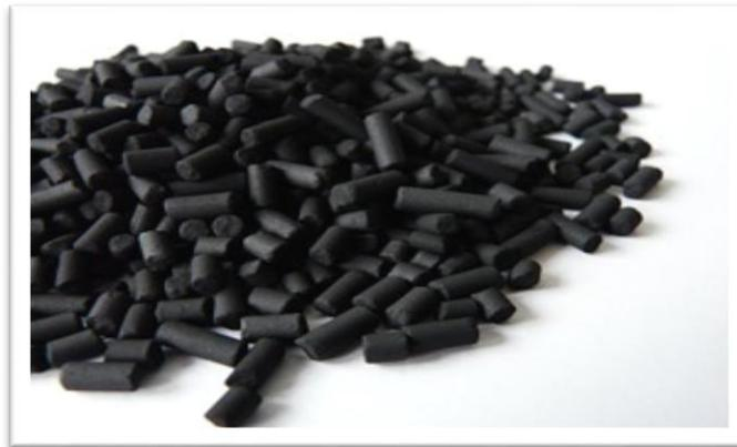
Figure III.4. Charbon actif extrudé (DESOTEC CHARBON ACTIF)
