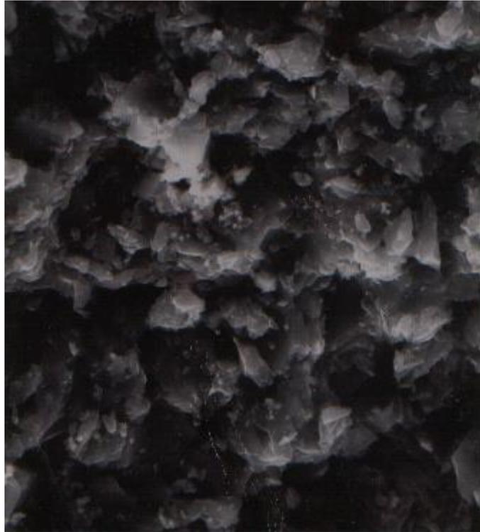
**Figure III.8.** Vue de la structure du charbon actif au microscope électronique
