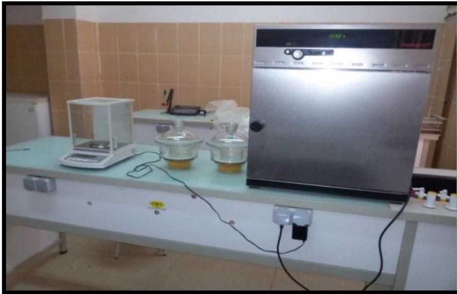
**Figure V.3.** Matériel utilisé pour la détermination du taux d'humidité
