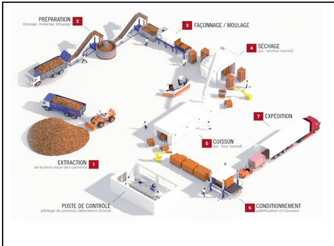
Figure 02: Etapes de fabrication des briques rouges. [10]
