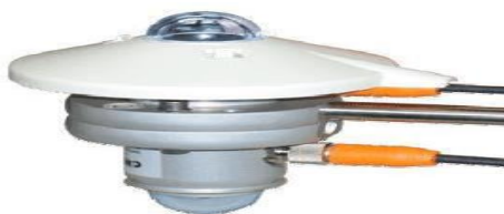
Fig. II-4 l'instrument de l'albédo- mètre [2]
