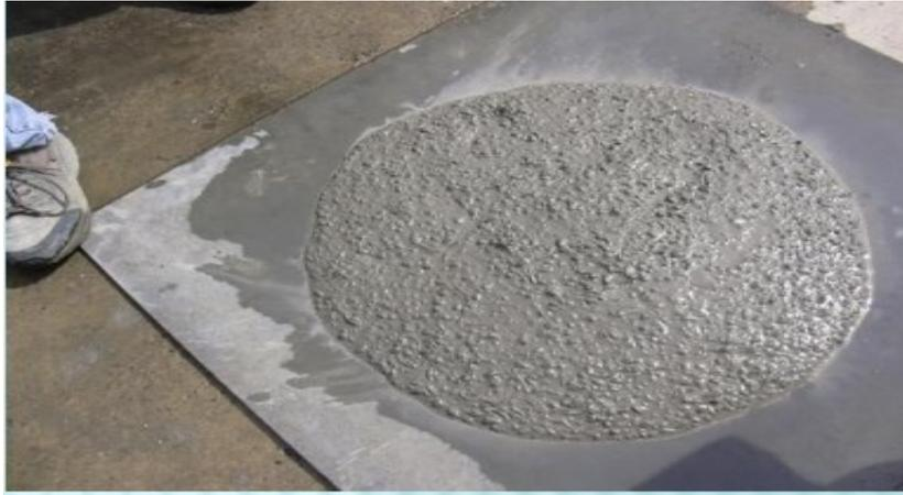
*Figure I. 6: bétons autoplaçants [20]*
