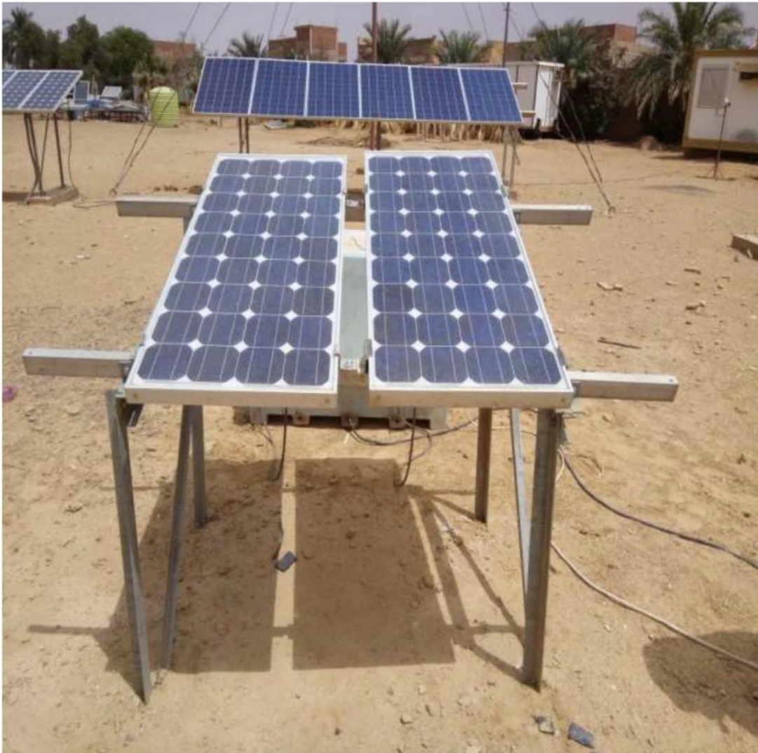
Figure III.1 : Photo du prototype de capteur PV/T étudié (URERMS Adrar)
