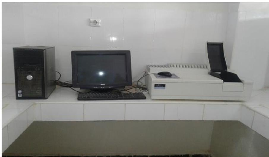
Figure II.9:UV-Visible pour mesurer la densité optique des éléments,
