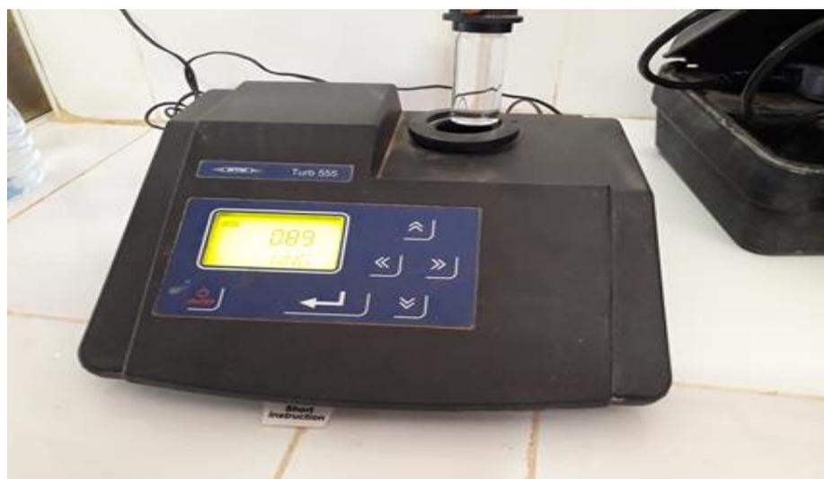
Figure II.2 Mesure de la turbidité
