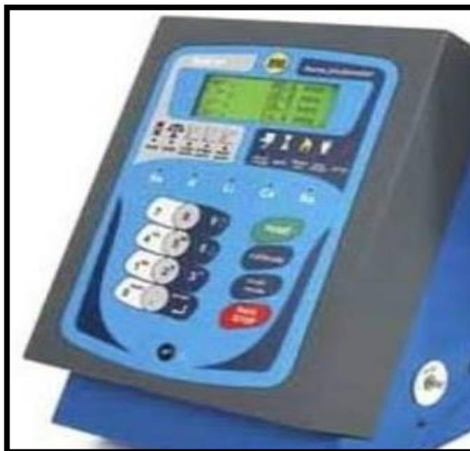
Figure II.3 Photomètre de flamme de type WTW
