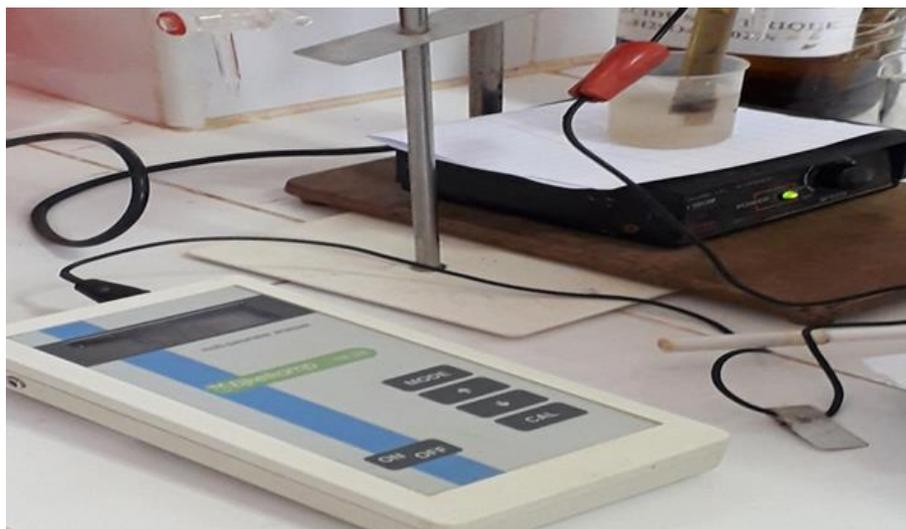
Figure II.1 Mesure du pH
