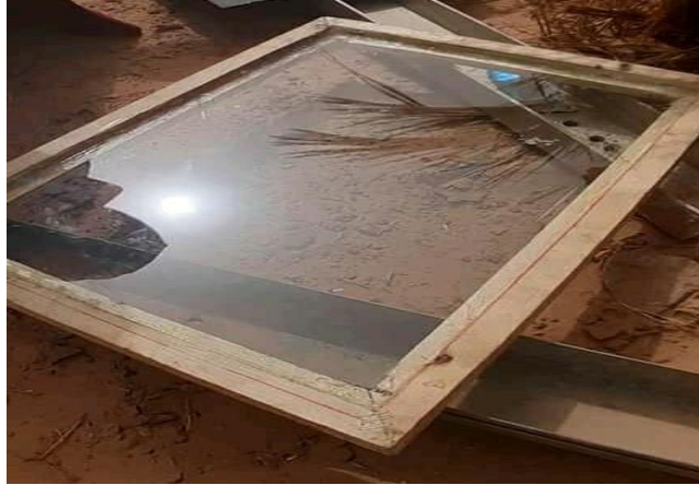
Figure IV.2 Couverture du capteur solaire
