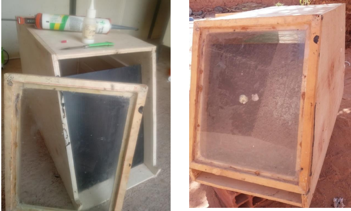
Figure IV.8: Montage de capteur avec le séchoir solaire
