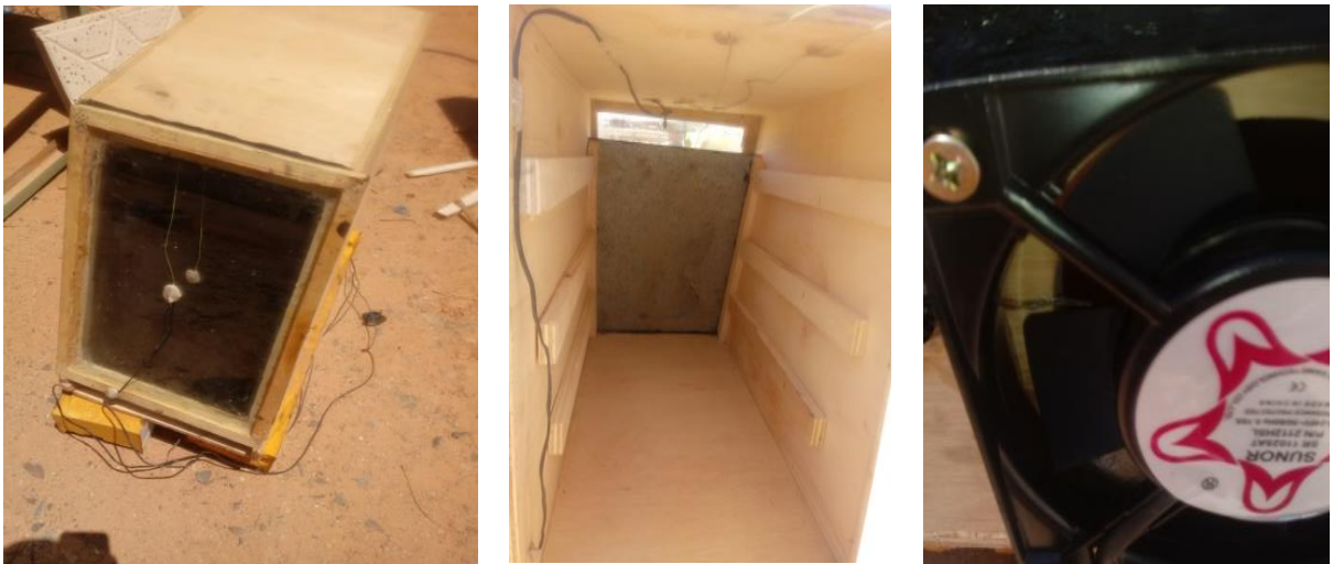
Figure IV.11 Raccordement des thermocouples dans le Séchoir solaire
