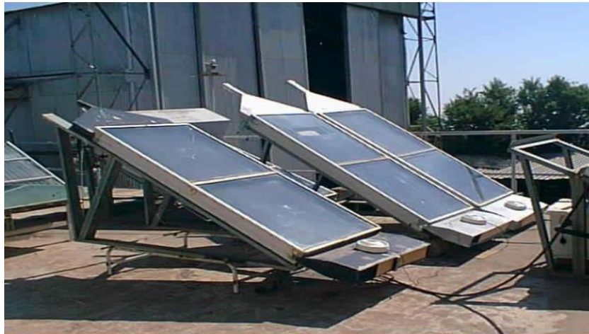
Figure II.10: Photo des différents types de capteurs solaires à air [13].
