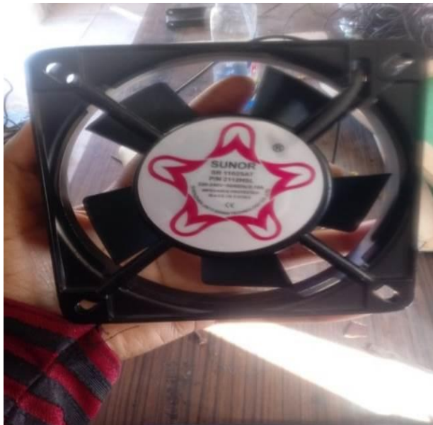
Figure IV.7 : Le ventilateur utilisé dans le séchoir solaire
