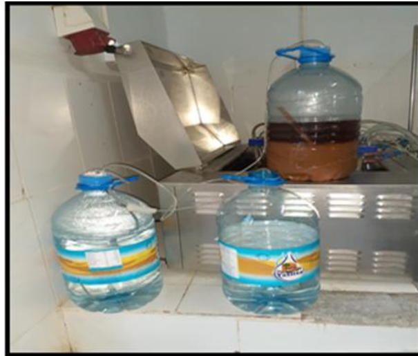
Photo III.12. Montage de récupération du CO 2 dégagé .
