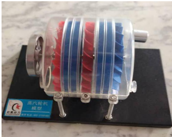
Figure III.10 : turbine à vapeur
