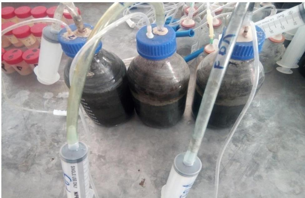
**Photo 04:** Digesteur utilisé remplie par l'iniculume et substrat .
