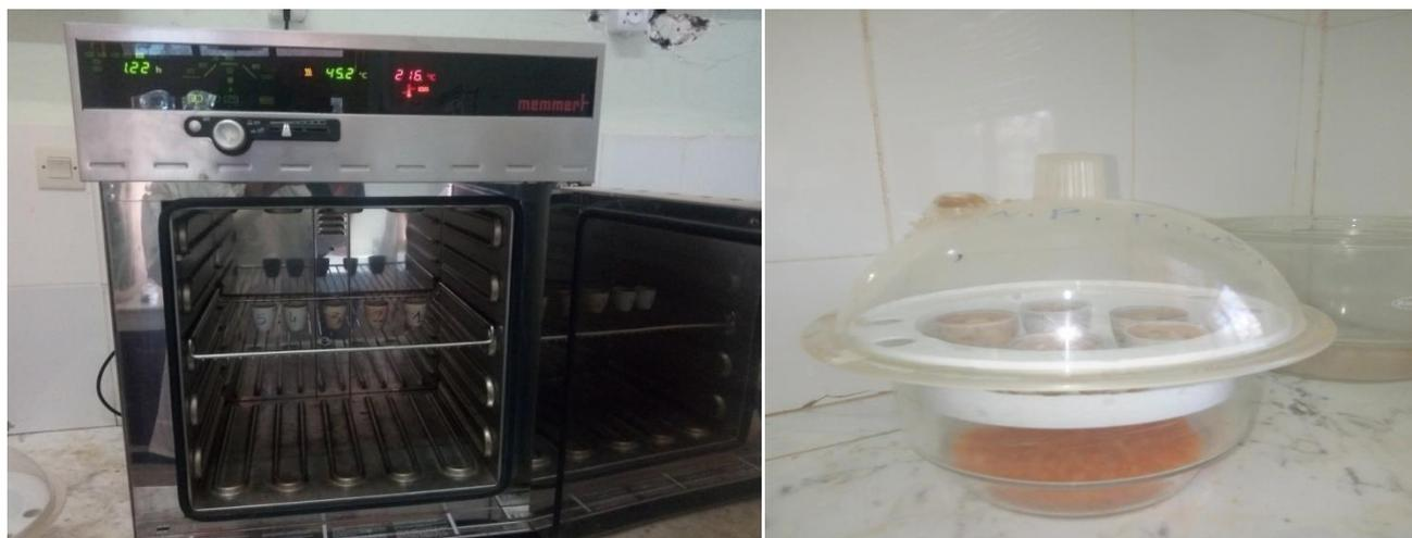
**Photo 06:** L'étuve utiliser et réglée à 105 °. **Photo 07 :** Photo de dessiccateur utiliser pour la refroidissement .
