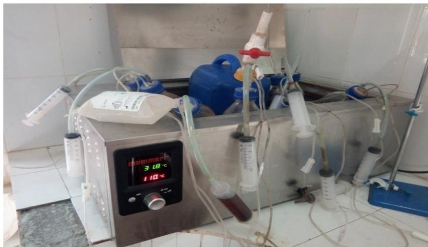
**Photo 05:** Les réacteurs dans un bain-marie chauffé et régulé à 37°C.
