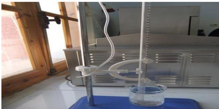
**Photo 12 :** Dispositif de mesure du volume du biogaz produit[43] .
