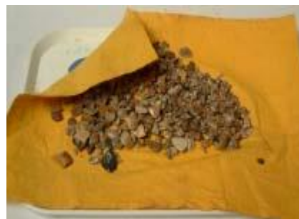
Figure II.16: Séchage de l'échantillon à l'aide d'un chiffon.
