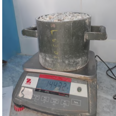
Figure II.4: Peser la masse du récipient rempli
