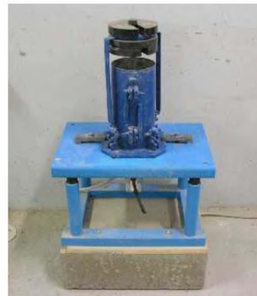
Figure I.4. Dispositif de mesure de la compacité [El Barrak, 2005].
