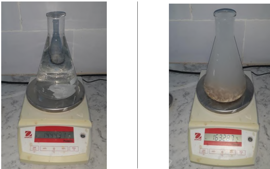
Figure II.7: La masse volumique par la méthode des éprouvettes
