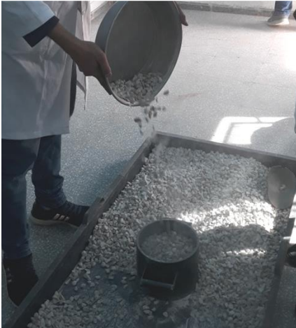
Figure II.3: Versement des granulats
