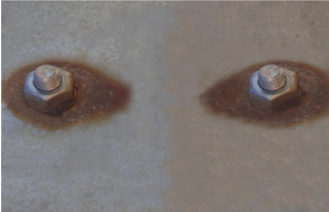
Figure 4.4: Effet d'une corrosion galvanique.
