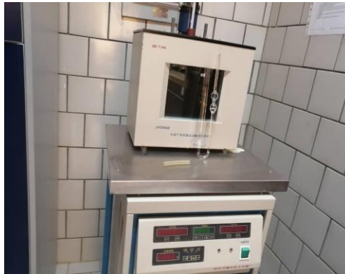
Figure III.13: Viscosimètre type : ASTM D 445.
