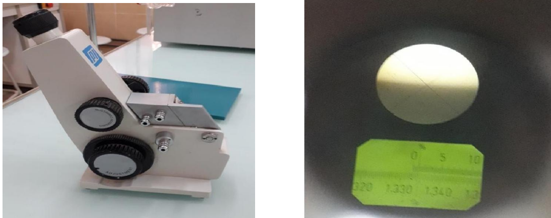
Photo IV.22: Détermination du taux de solide soluble à l'aide d'un réfractomètre
