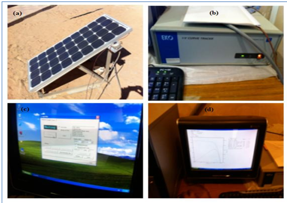
Figure III-3: Photos de banc d'essai : (a) Module PV à caractériser, (b) Traceur de courbe I-V de type EKO Instr MP-160, (c, d) Résultats expérimentaux affichés sur le PC.
