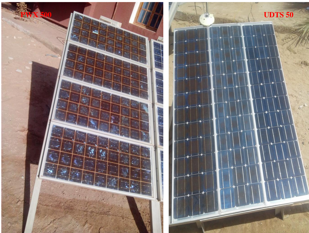
Figure III. 5-(A-B): la décoloration d'un module PV (PWX 500 - UDTS 50).
