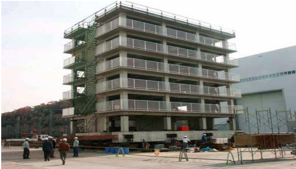
Photo 3:Exemple de structure réelle testée sur table vibrante (Miki) [Sollogoub, 2007]:
