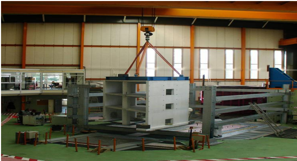
Photo 2: Essai Seismique sur une structure en béton armé (CEA) [10]
