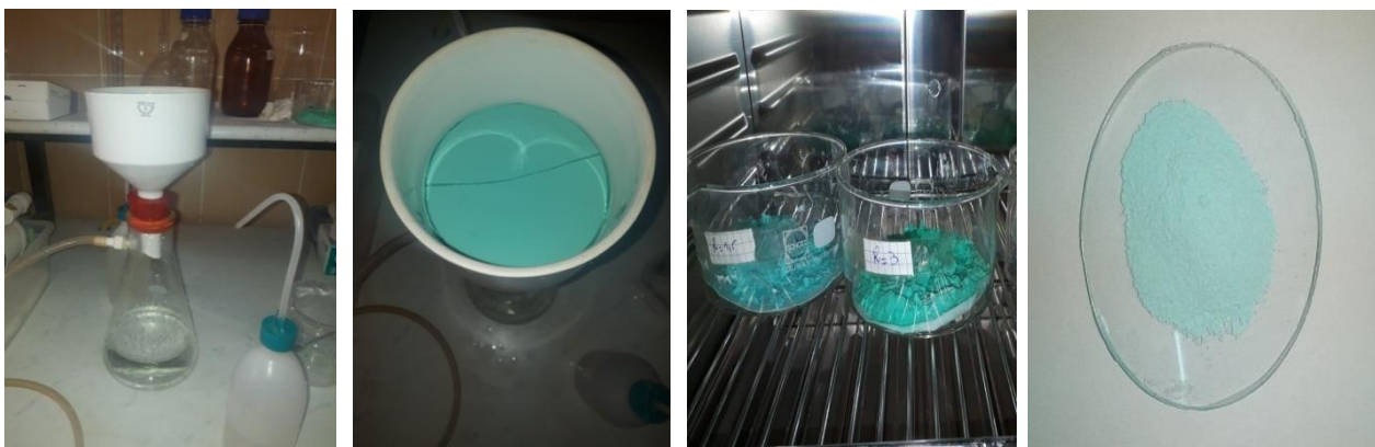
Figure IV.1. Différentes étapes de la synthèse des matériaux Ni_RAl-CO_3
