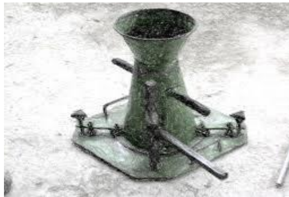
Photo III – 5 : Essai de cône d'ABRAMS [17]
