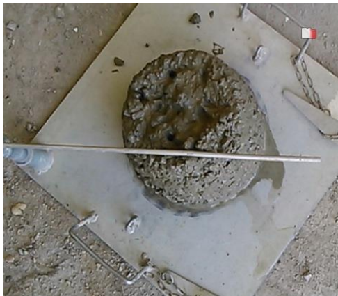
Photo III – 5 : Essai de cône d'ABRAMS [17]
