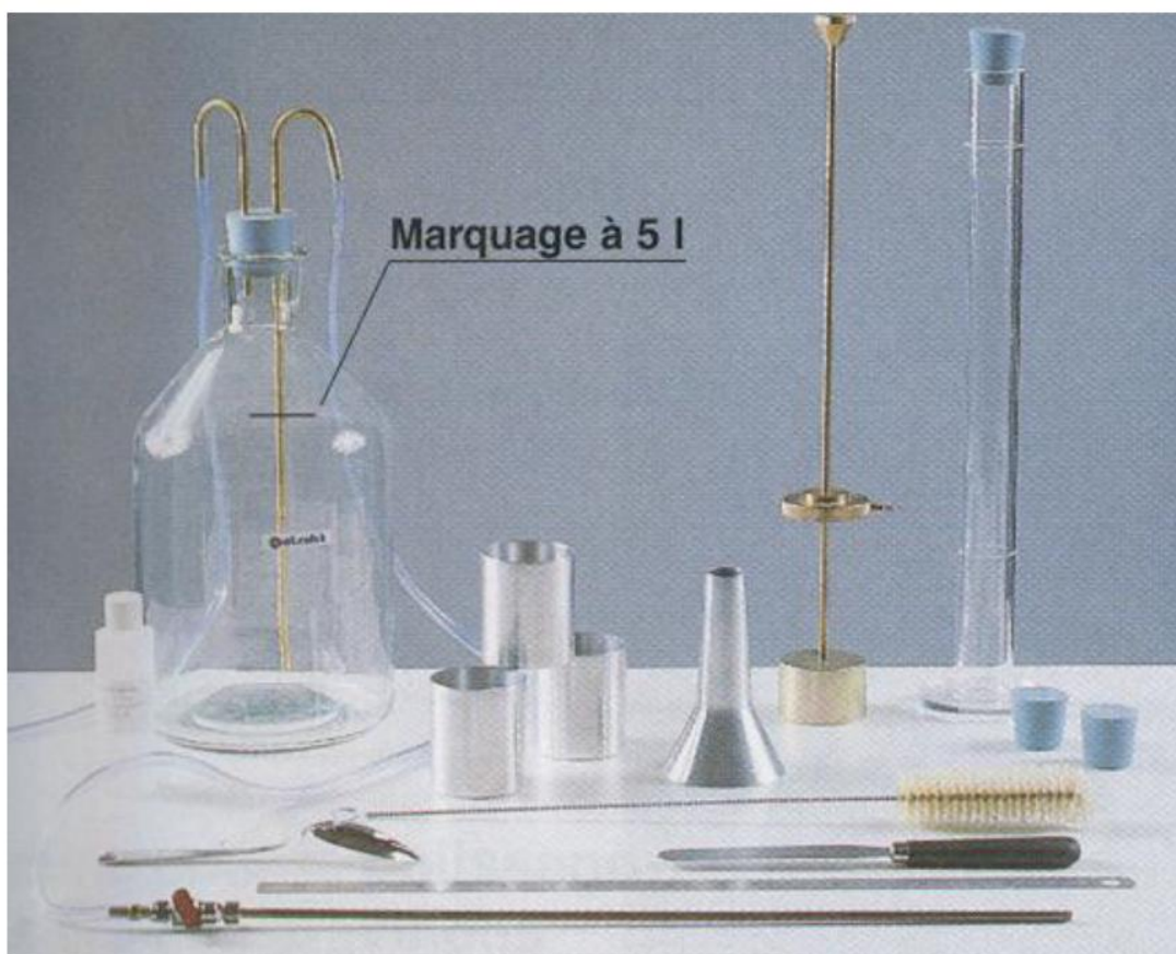
Photo III.3 : Matériels utilisés pour l'essai d'équivalent de sable.
