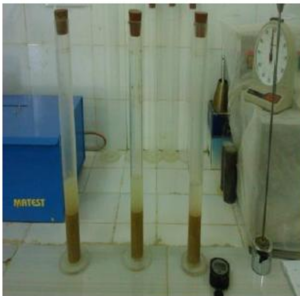
Photo III- 4 : Essai d'équivalent de sable [17]
