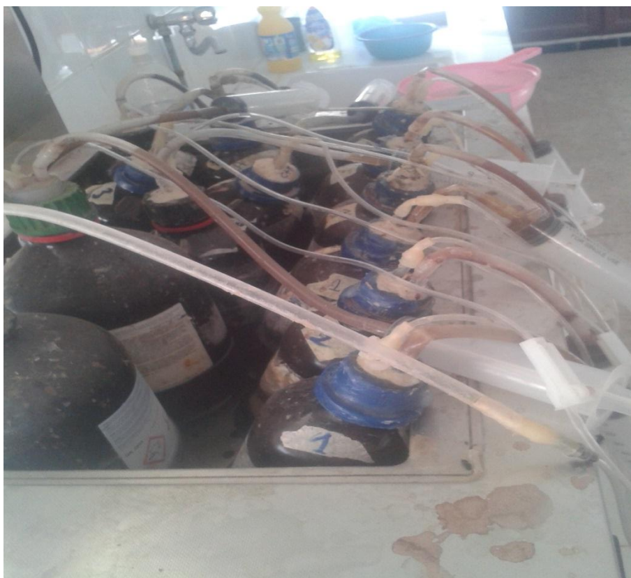
Fig III.3:des Réacteursplonger dans un bain marri à T° fixe.
