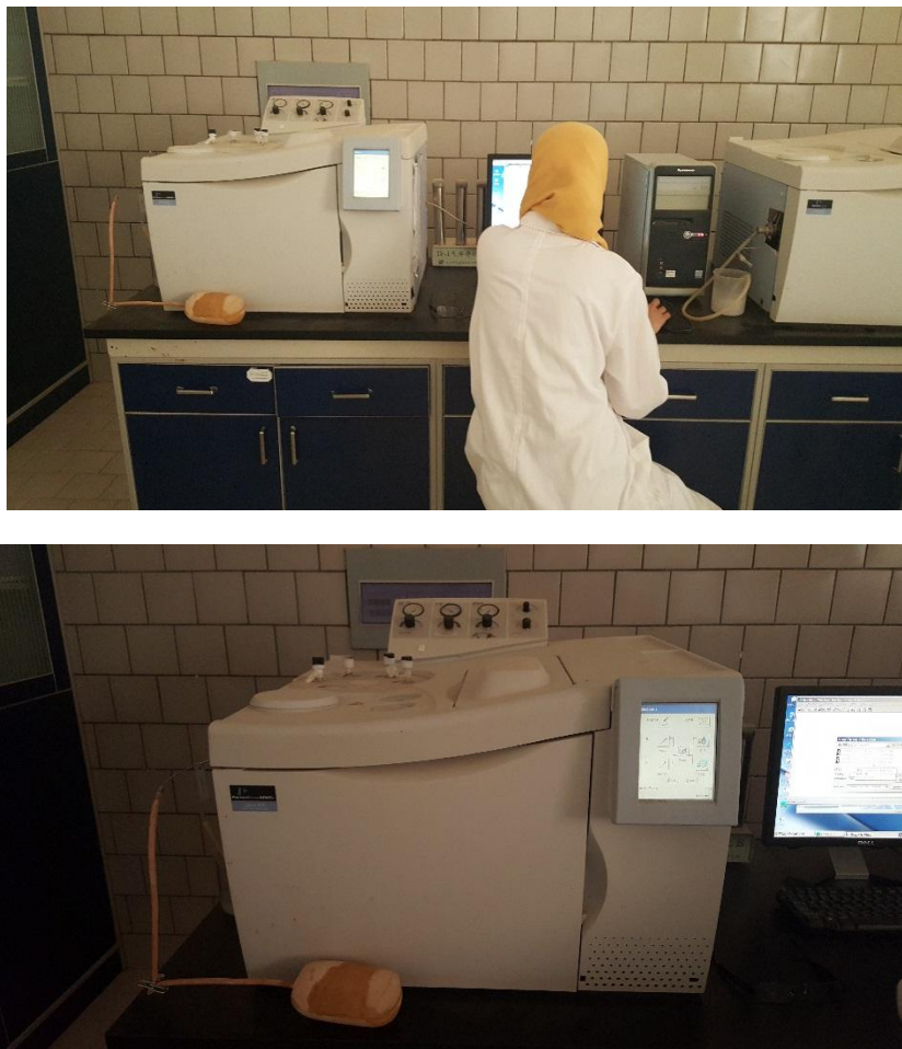
Fig III.5: Méthode d'injection de biogaz par la chromatographie
