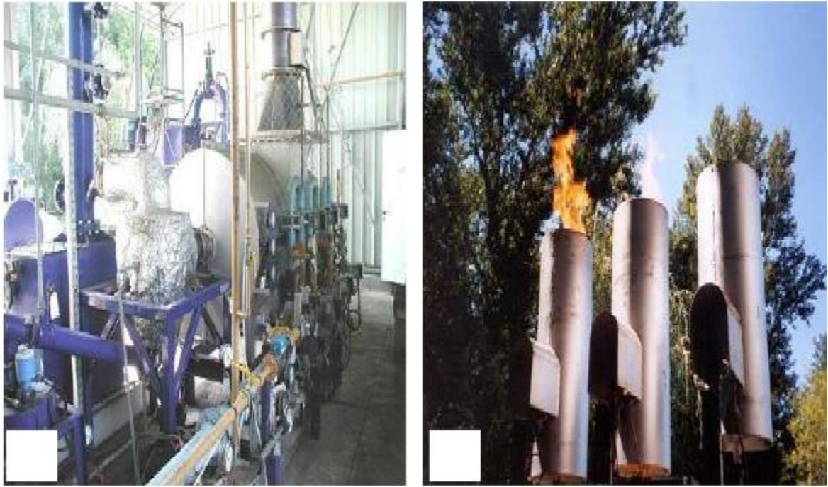
FigI.5 : (a) Four de la thermolyse [16], (b) Combustion du gaz de la thermolyse [2].
