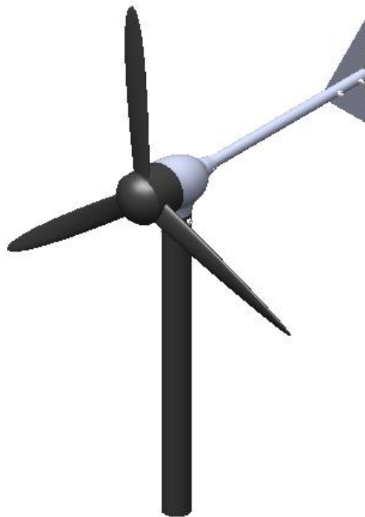
Figure III.1 : Éolienne à axe horizontale WHISPER (MODELE Whisper 100)
