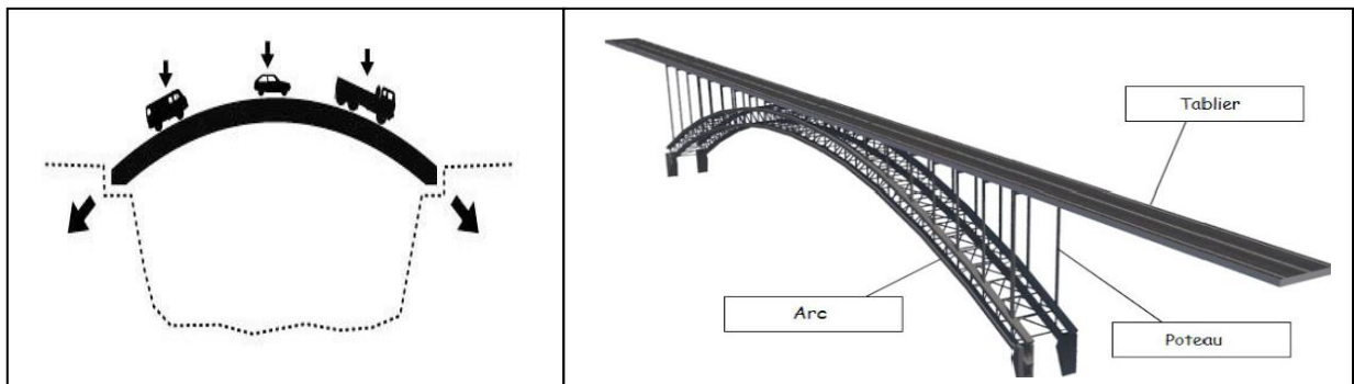
Figure II.5 : différentes parties d'un Pont en arc [14]
