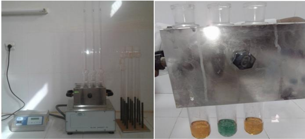
Photo IV.15: Echauffement du mélange( échantillon + réactif ) .
