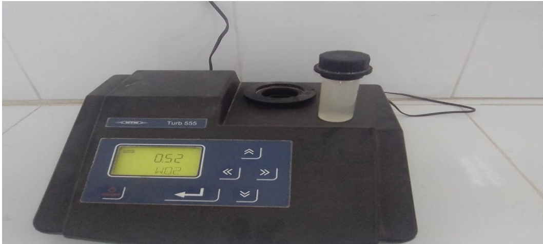
Photo IV.8 : La mesure de la turbidité.
