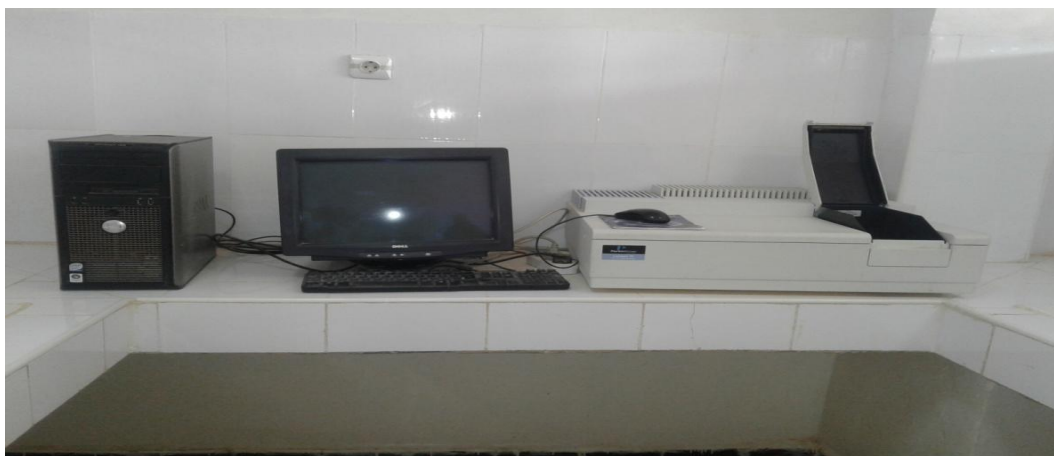
Photo IV.13 : UV-Visible pour mesurer la densité optique .
