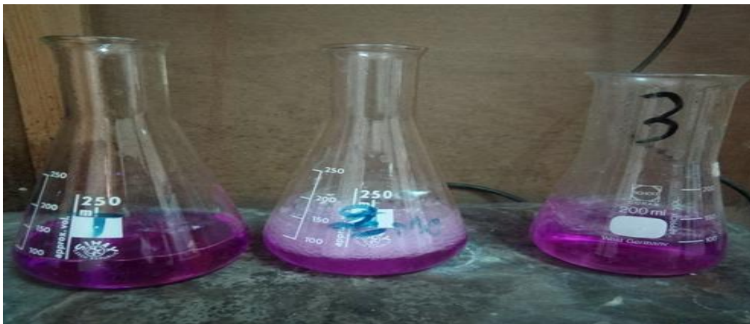
Photo IV.14 : Echauffement du mélange (réactif + échantillon) .
