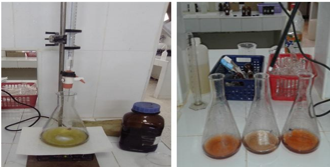
Photo IV.16: Titrage de l'excès de dichromate de potassium .
