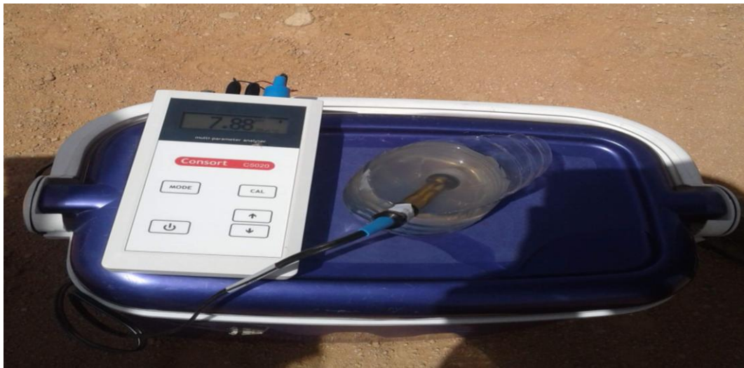
Photo IV.4: La mesure du pH et de la température.
