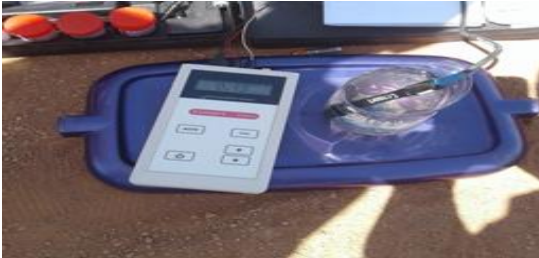
Photo IV.6 : la mesure de l'oxygène dissous.
