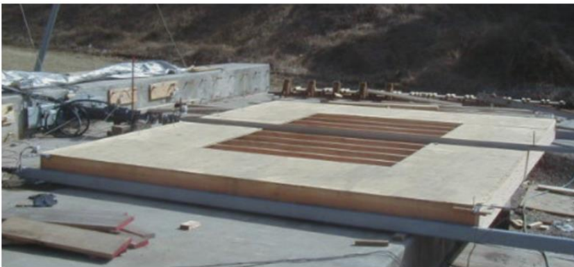
figure I. 42: Plancher de 5 x 6 m avec ouverture centrale
