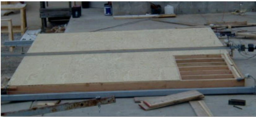
figure I. 41: Plancher de 5 x 6 m avec ouverture
