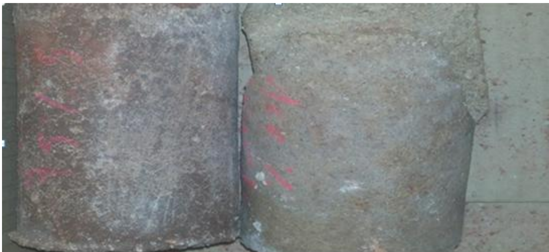
Figure(III.23) : compression d'échantillon de 75%S+25%A (auteur).
