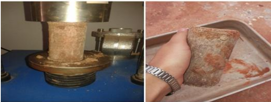
Figure(III.23) : compression d'échantillon de 75%S+25%A (auteur).
