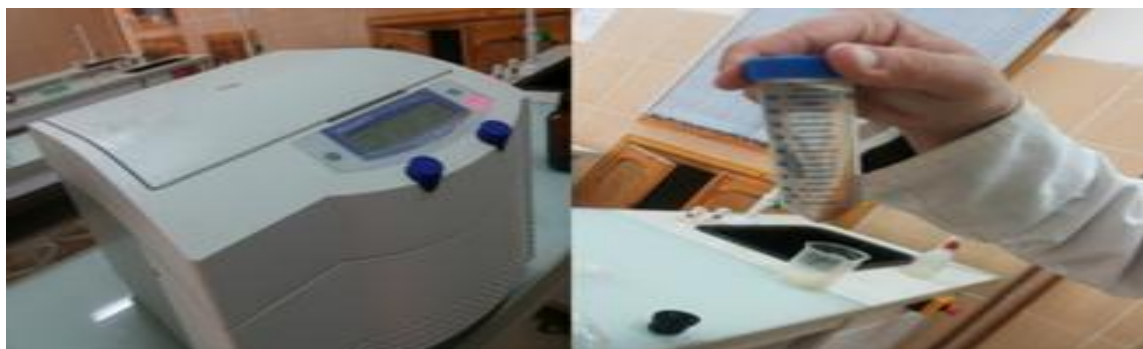
Figure (III.13) : décentration d'argile avec la centrifugeuse, bloc chimique .unv d'ADRAR (auteur).
