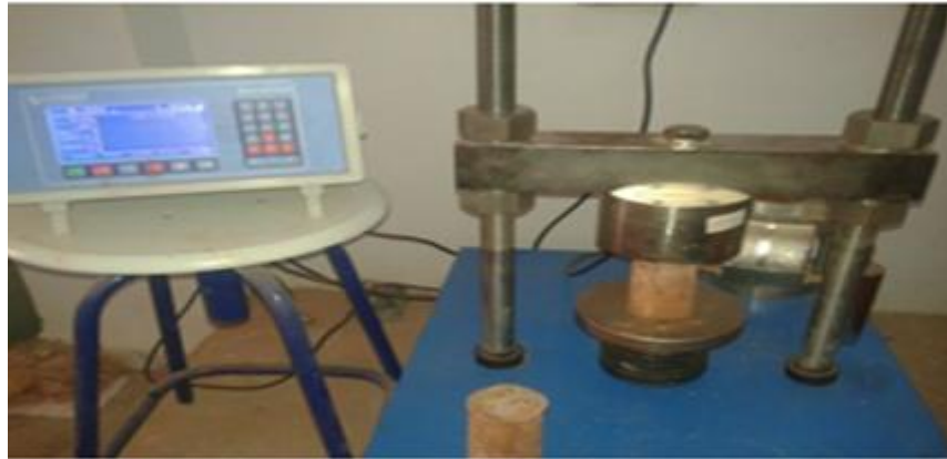
Figure(III.32) : écrasement d'échantillon (auteur)
