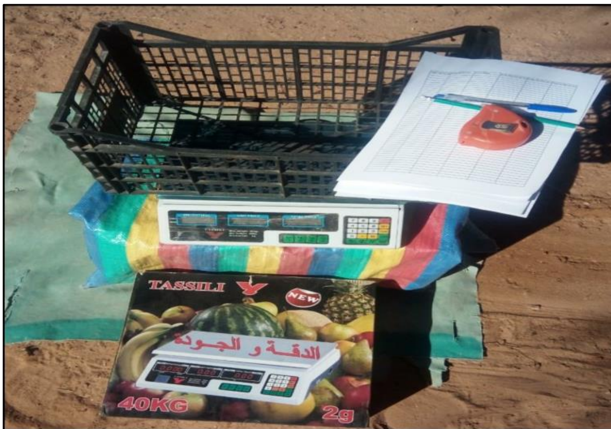
Photo4: Matériel utilisés :mètre ruban, balance numérique et caissette en plastique (Photo originale, Janvier/2019).
