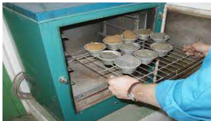
Photo II.2: Essai de la teneur en eau
