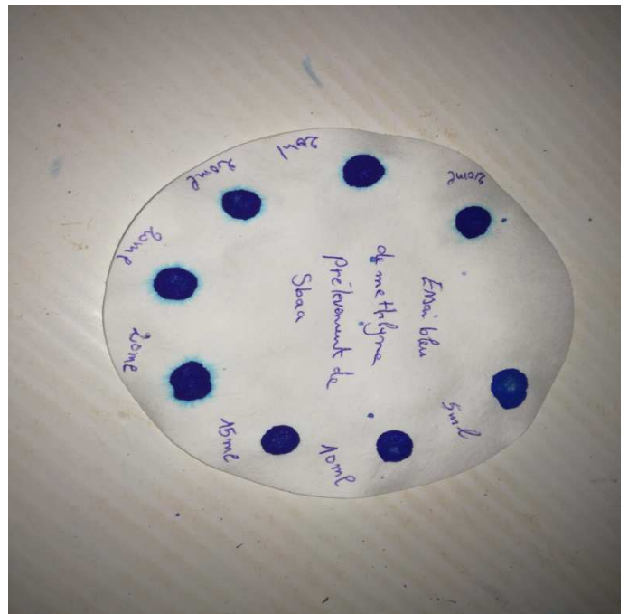
Photos IV.5 et IV.6 : Les résultats des essais valeur au bleu de méthylène
