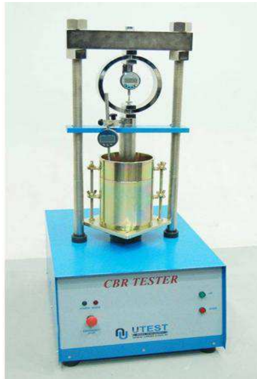
Photo II.9 : Machine pour le poinçonnement CBR
