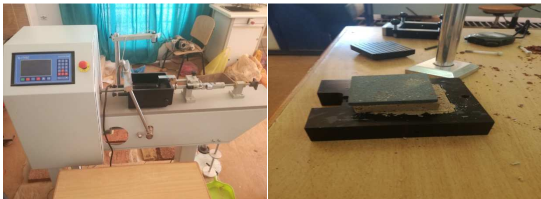
Photo II.11: Réalisation de l'essai de cisaillement à la boîte (a et b)
