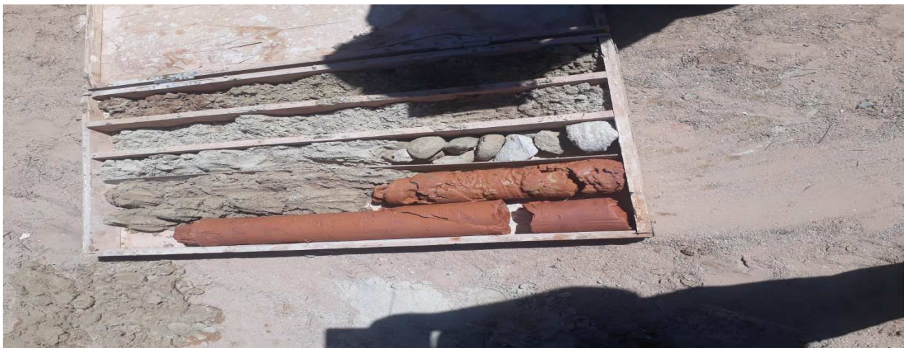
Photo I.1 : Caisse à carottes de conservation des échantillons prélevés
