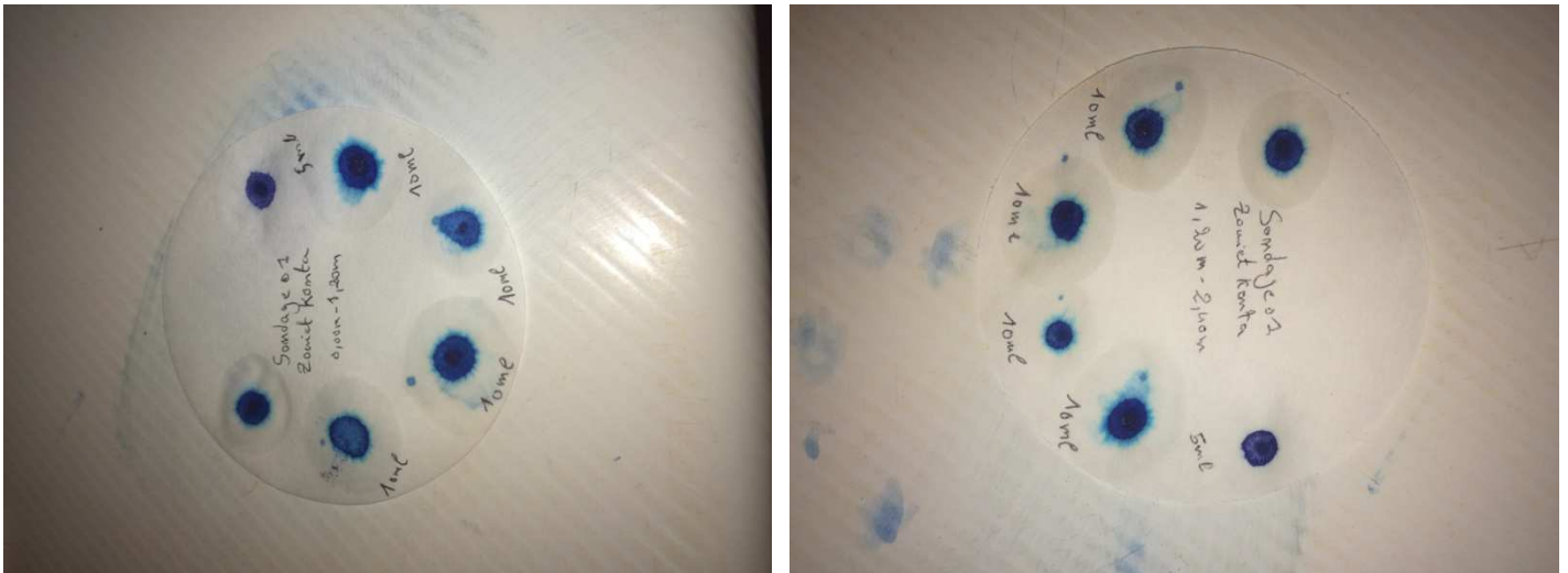
Photos IV.1 et IV.2 : Les résultats des essais valeur au bleu de méthylène
