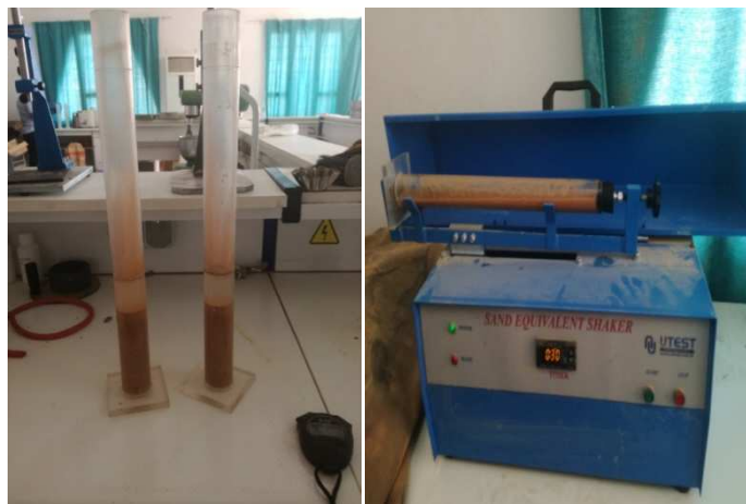
Photo II.6 : Essai d'équivalent de sable
