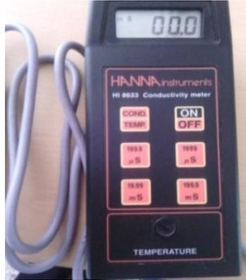
**Photo (IV-4) :** Le Conductimètre utilisé.
