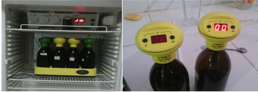
**Photo (IV-20) :** Mesure de DBO<sub>5</sub>.
