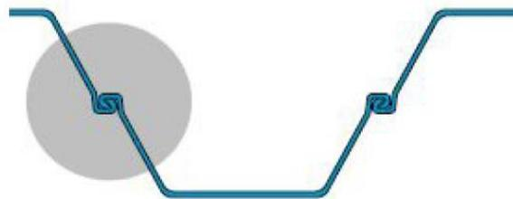
**Fig. 1.55.** Etanchement avec combinaison bentonite ciment.
