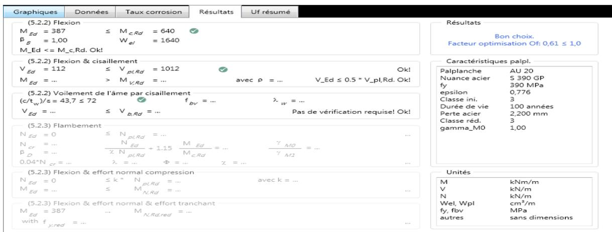
Fig.4.2. Fenêtre des résultats de logiciel durabilité
