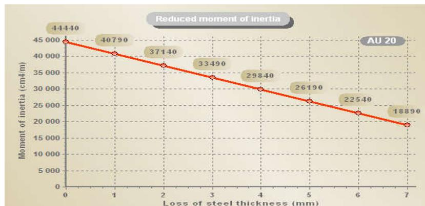
Fig. 4.4. Moment d'inertie réduit
