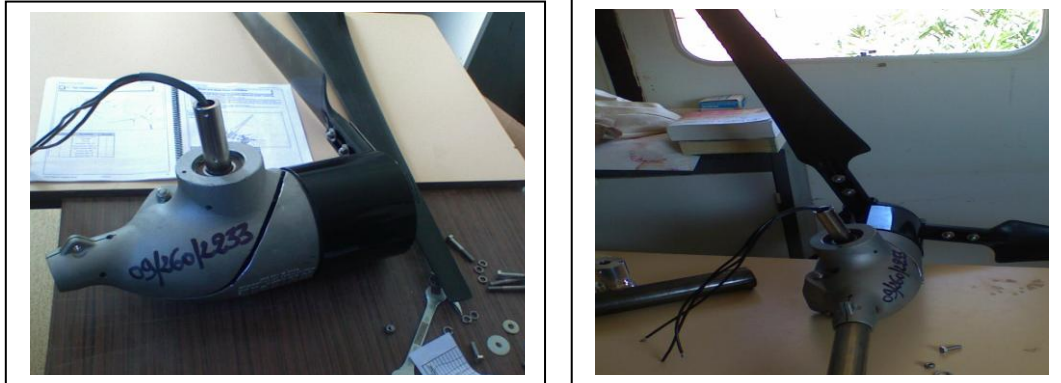
Figure. (VI- 11): Schémas représente les différentes étapes pour le montage des pales avec l'aérogénérateur
