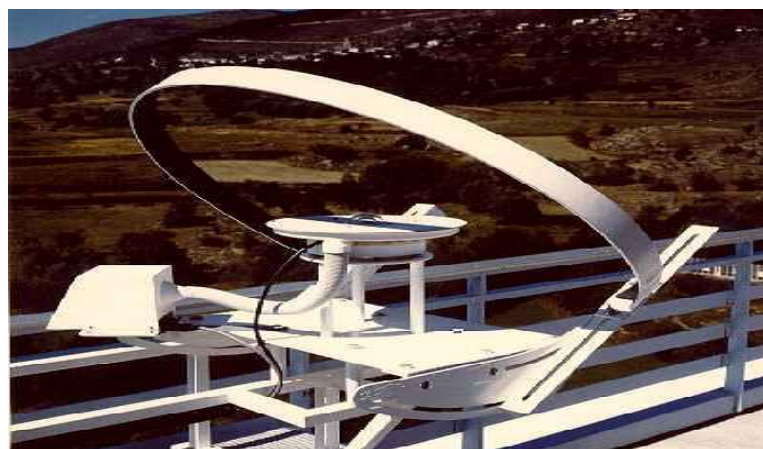
Figure (II-12 -b) : Un pyranomètre bande pare-soleil pour la mesure du rayonnement solaire diffus, où l'ombre de la bande apparaît sur la demi-sphère de l'instrument [1]
