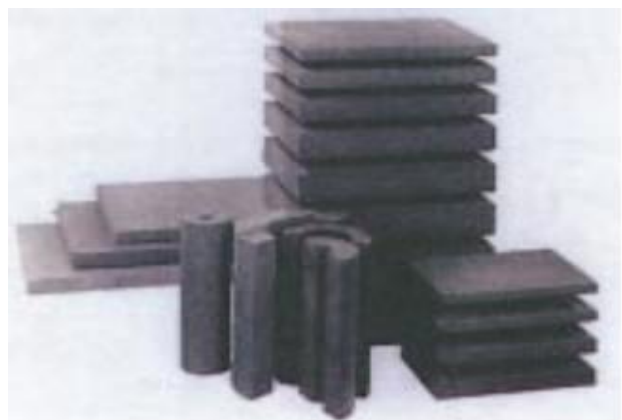
Figure III-3 : verre expansé : bloc, plaques et coquilles.
