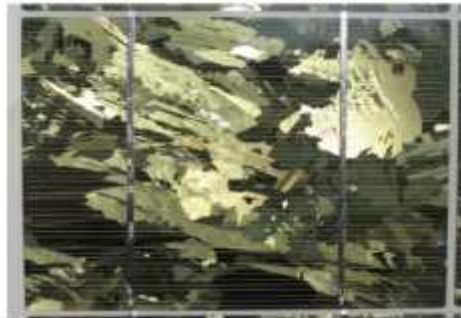
Figure (1-8): La cellule en Silicium polycristallin [8].
