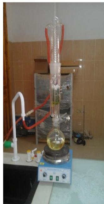
**Figure(13):** schéma d'un appareil Soxhlet
