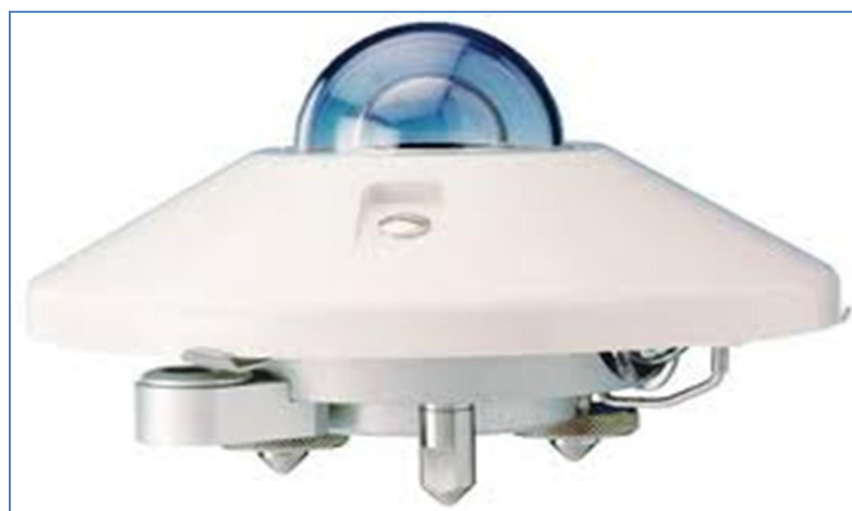
Figure I.2 : Pyranomètre pour la mesure de l'éclairage global horizontal [2]
