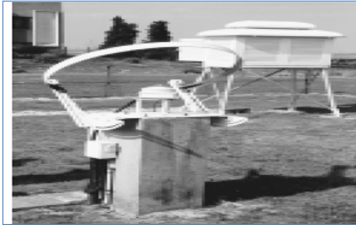
Figure I.4: Diffusomètre pour la mesure de l'éclairement diffus.
