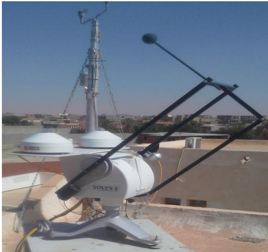
Figure 4.1 : Appareil de mesure de l'irradiation direct Pyrhéliomètre.
