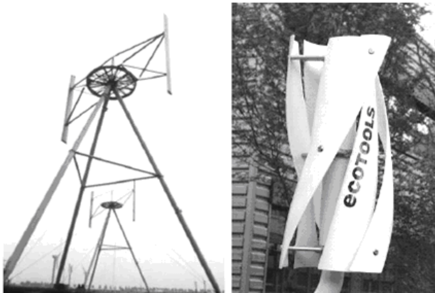
Figure I. 13. Exemples des constructions Darrieus (Darrieus de type H) et Savonius [52]
