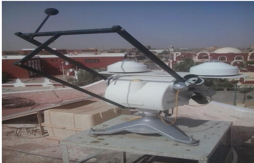
Figure I.8 : Photos de la station météorologie (enerMENA High Precision Meteorological Station) installée à URER/MS
