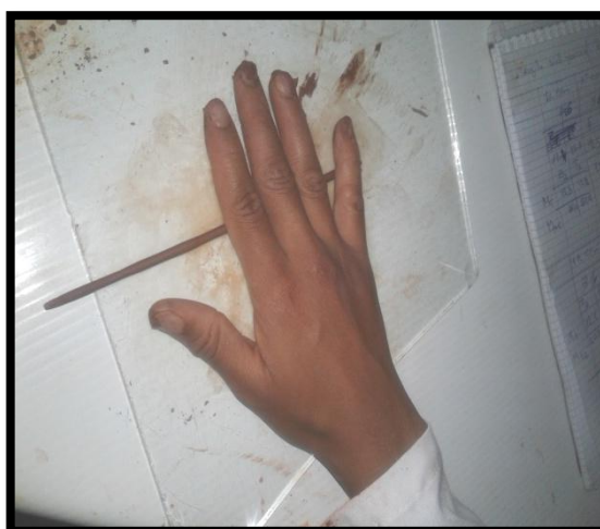
Figure II.9 : Mode opératoire de la limite de plasticité
