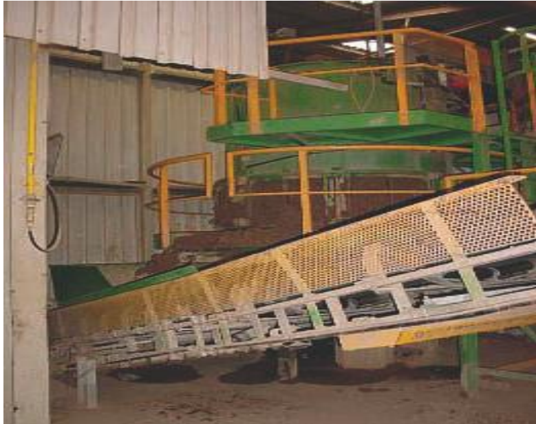
Figure J.15 : Broyage et malaxage de l'argile
