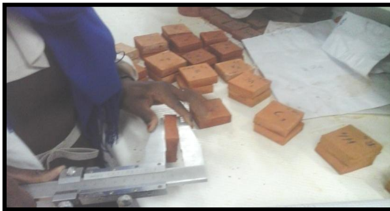
Figure III.5 : Retrait linéaire après séchage.
