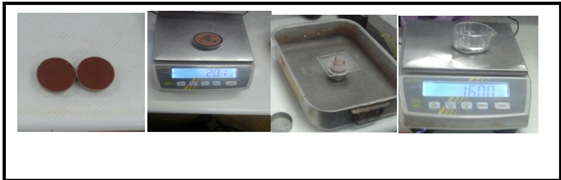
Figure II.11 : Mode opératoire de la limite de retraites.
