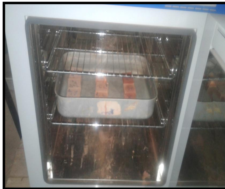
Figure III. 4 : Séchage à l'étuve.
