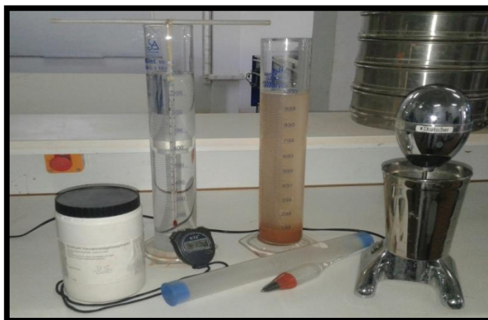
Figure II.4 : Appareillage de l’analyse granulométrique par sédimentation
