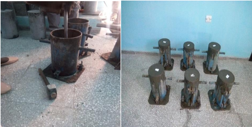
Figure 20 : mis en place par piquage Figure 21 : Moulage des éprouvettes
