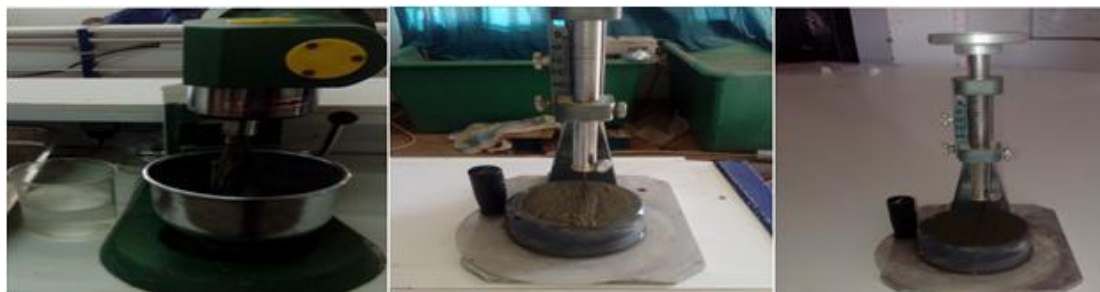
Figure II.6 : Malaxeur et l’appareil de Vicat. [3]
