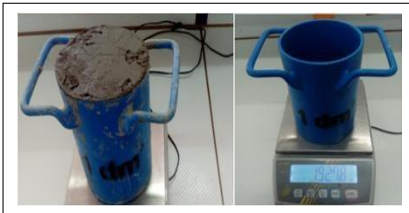
Figure III.23: Essai de la masse volumique du béton
