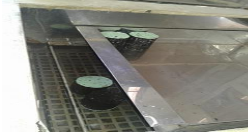
Photo (13) : Les éprouvettes dans un bain normalisé de 18°C
