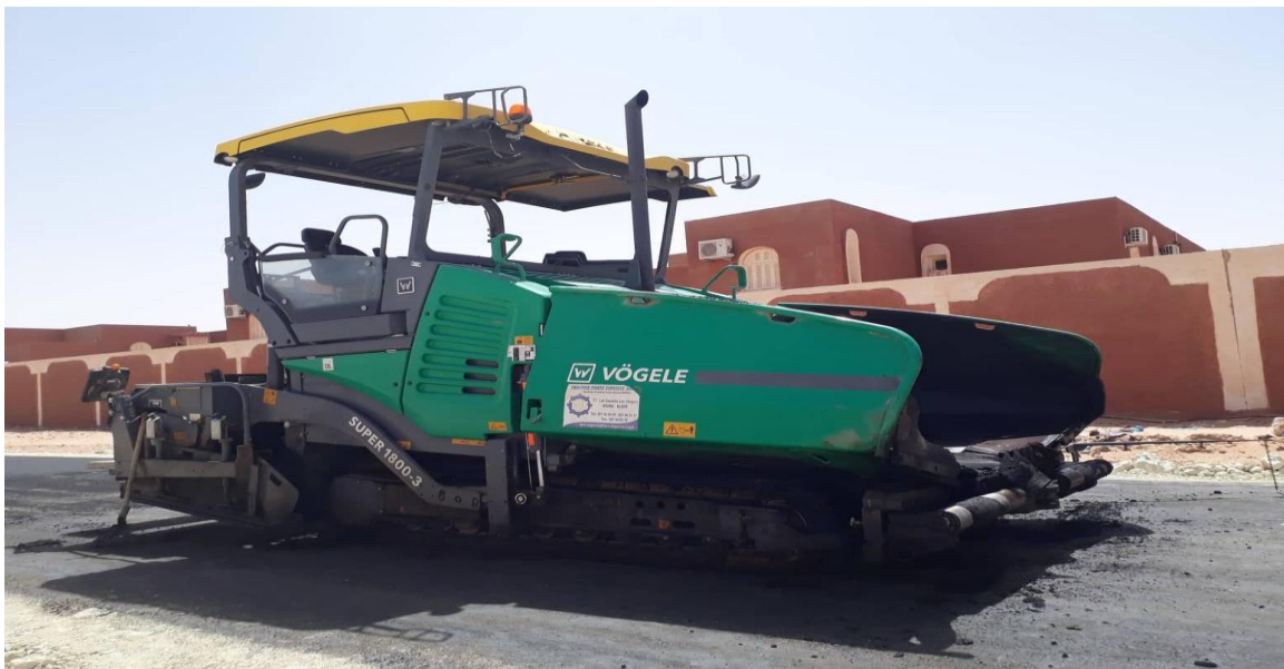
Figure (8) : Finisseur enrobé
