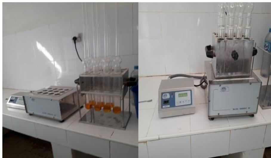
Photo III-14 : Echauffement du mélange (échantillon + réactif).
