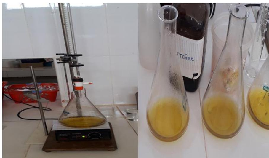
Photo III-15 : Titrage de l'excès de dichromate de potassium.
