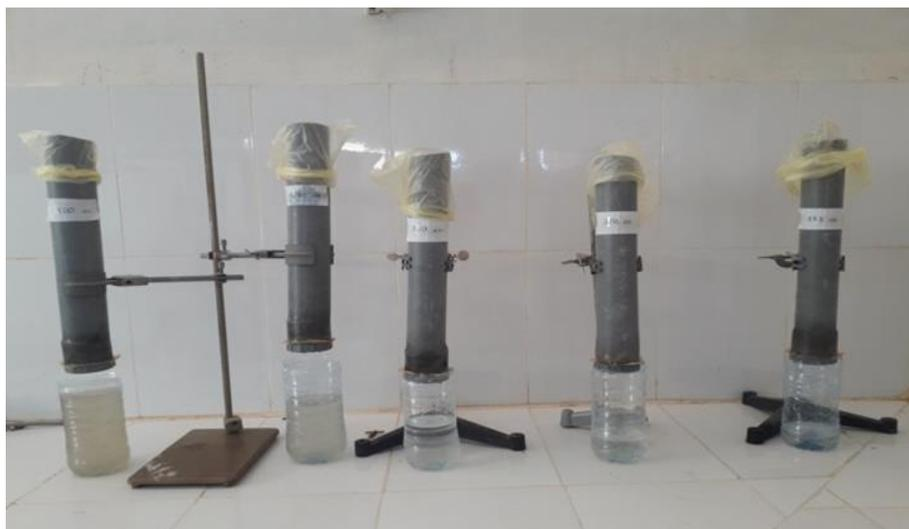
Photo III-4 : dispositif de filtration.
