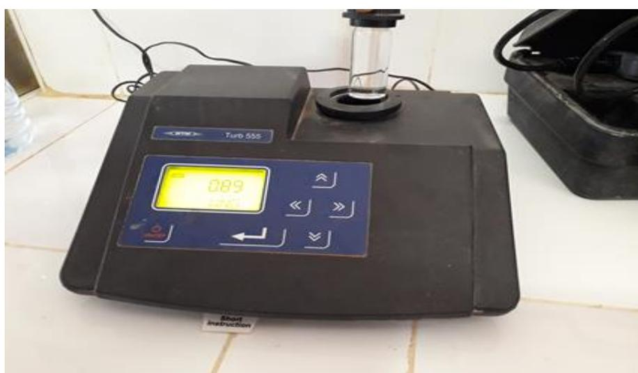
Photo III-7 : Mesure de la turbidité.
