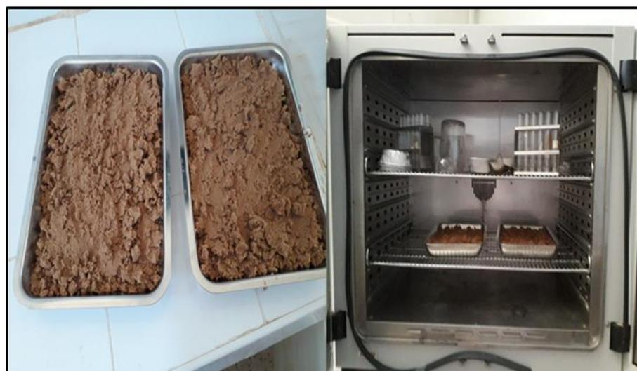
Photo III-2 : Opération de séchage du sable.
