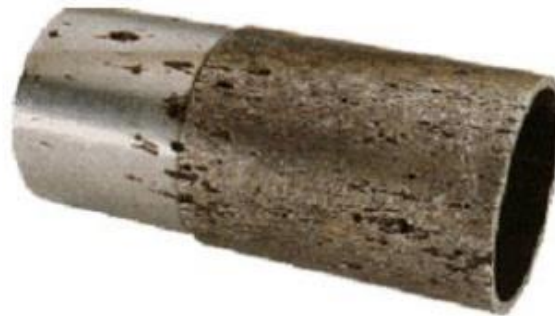
Figure 4 :Corrosion par piqûres d'un acier inoxydable [2]
