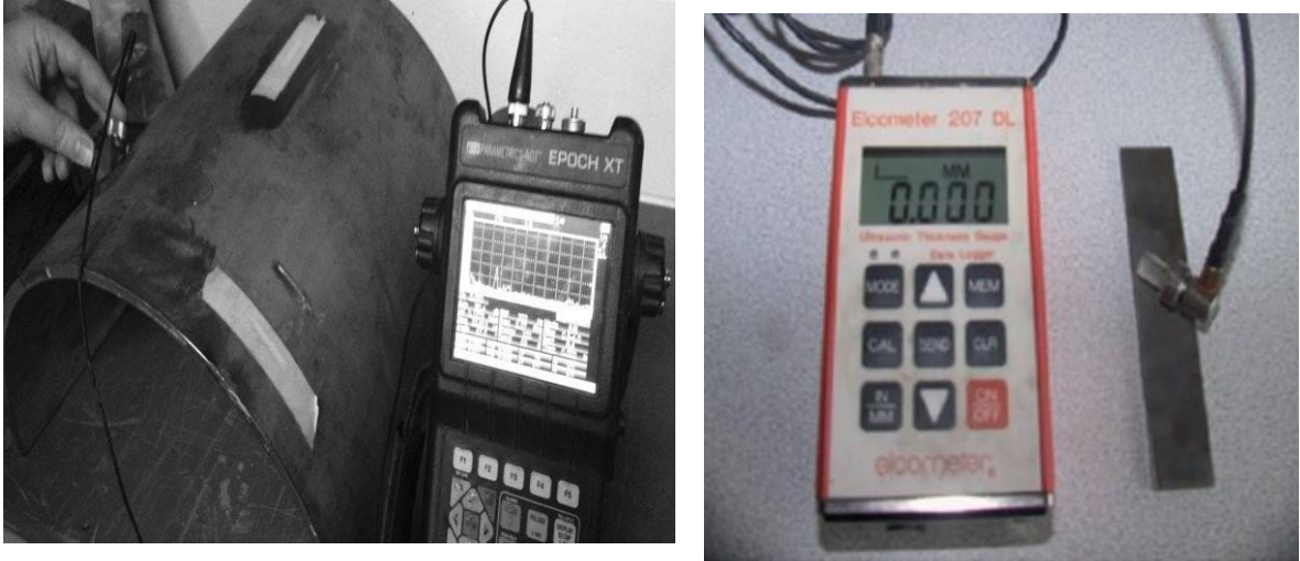
Figure 22:Essais non-destructifs Contrôle par ultrasons
