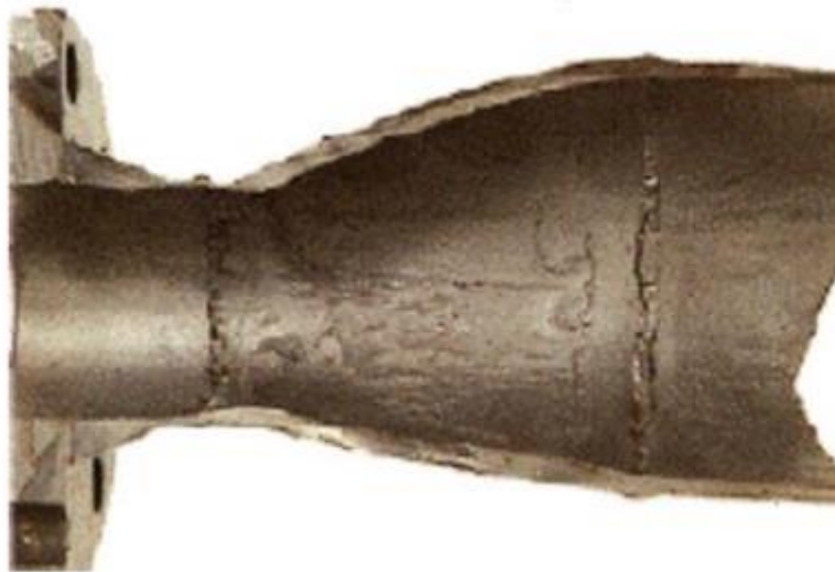
Figure 8: Corrosion-érosion dans une zone turbulente [2]
