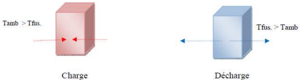
Figure II.16: Stockage et le déstockage de chaleur latente. [12]
