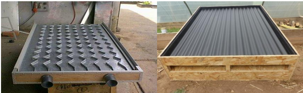
Figure II.8 : Capteur à air avec les obstacles (chicanes longitudinales).[4]
