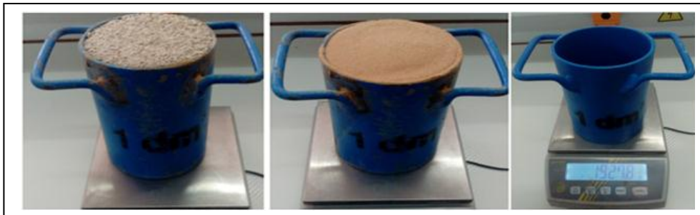
Figure II. 9:essai masse volumique de sable de dune et concassé.
