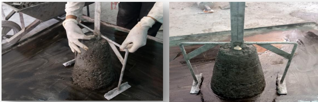
Figures IV.7 : Mesure de l'affaissement
