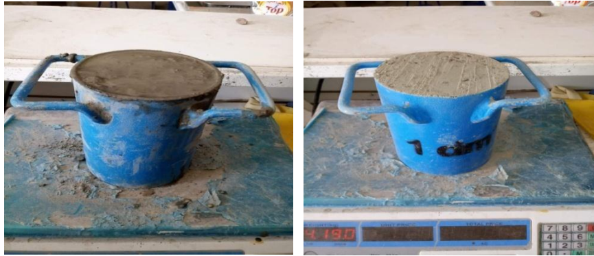
Figures IV.6 : L'essai de la masse volumique du béton frais
