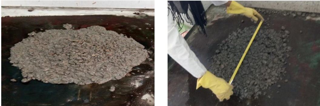
Figures IV.8 : Mesure de l'étalement
