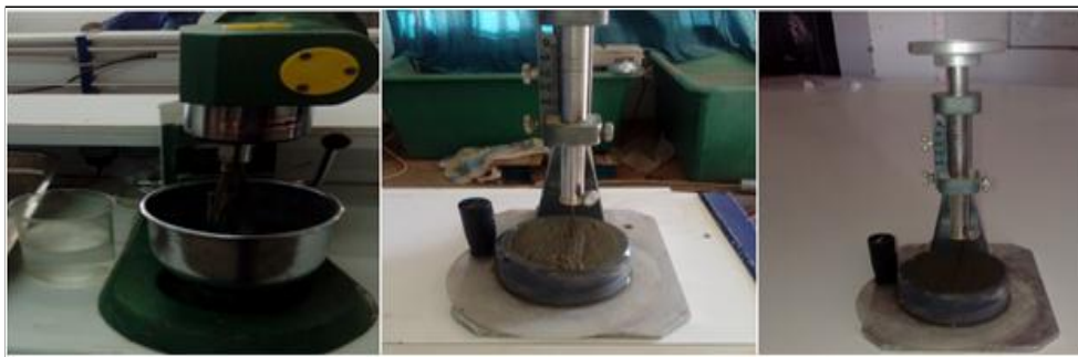
Figure II. 5 : Essai de prise du ciment.
