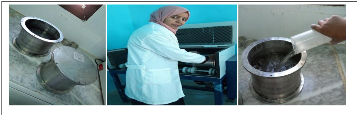
Figure II. 13: Tambour avec billes en acier et gravi et Appareil Micro-Derval
