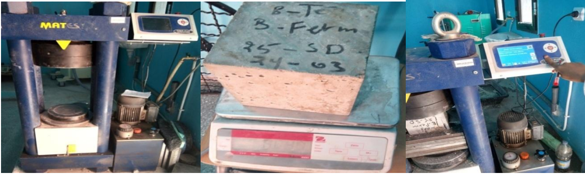
Figure IV.12 : essai et machine de écrasement donne Laboratoire «L.T.P.S».
