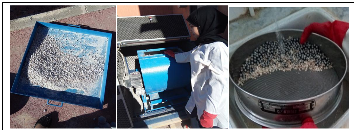
Figure II. 14 : Appareil de Los Angeles
