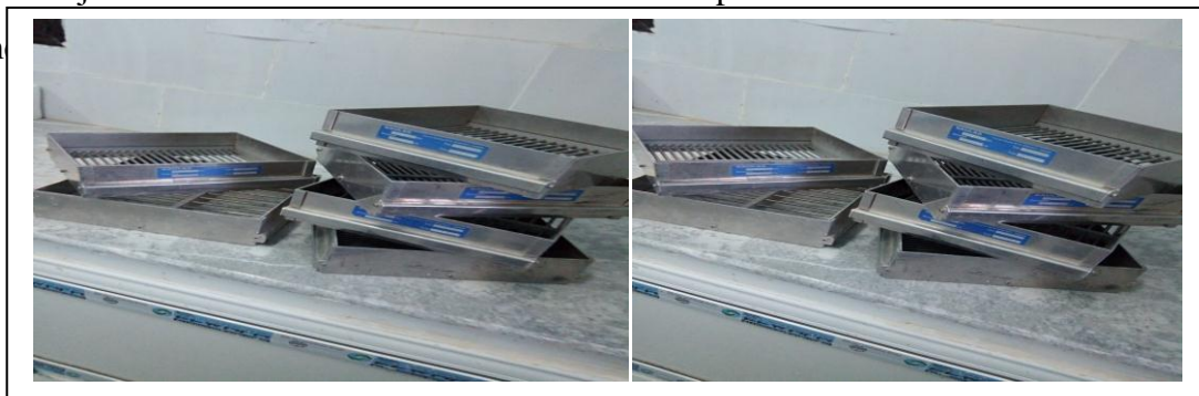
Figure II. 15:Tamis normalisés à mailles carrées
