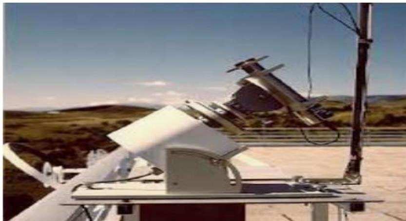
Figure I.17 : Un pyréliomètre pour la mesure du rayonnement solaire direct [6, 23].
