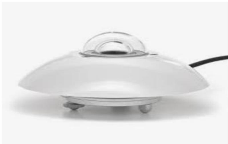
Figure I.16 : Un pyranomètre d'Eppley [25].
