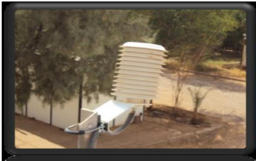
Figure I.21 : Capteur de température
