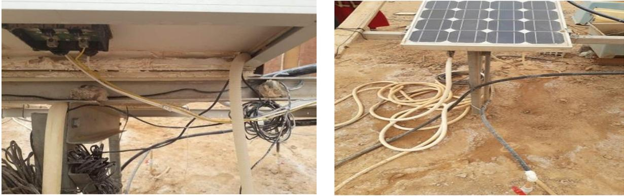
Figure IV.4 : Photos des thermocouples de type « K »
