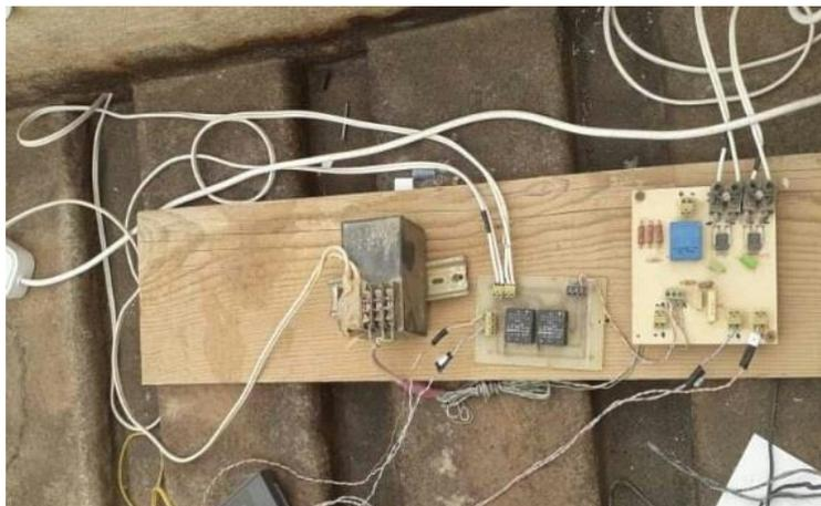
Figure IV.5 : Photo du capteur de courant et capteur de tension
