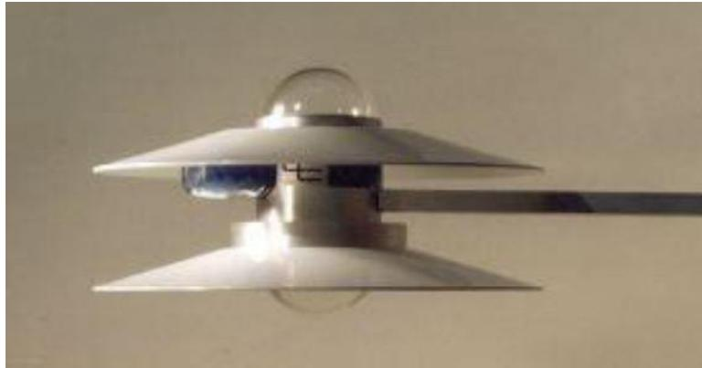
Figure I.18 : L'albédomètre pour la mesure de l'albédo du sol [6]
