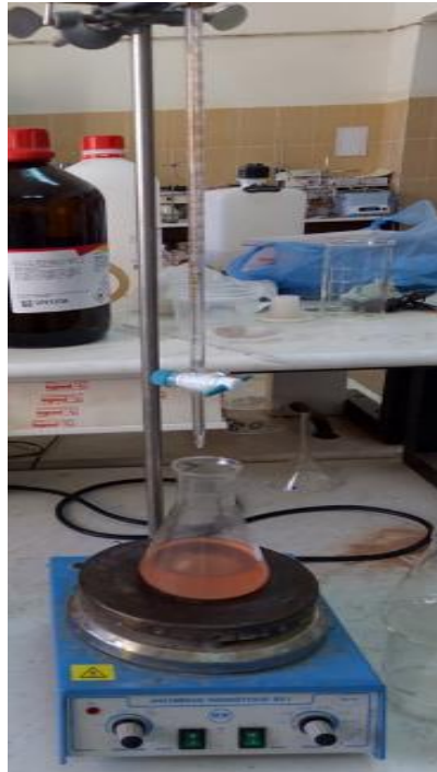
Photo 4-9 : Le processus de titrage pour l'identification de l'indice d'acide.
