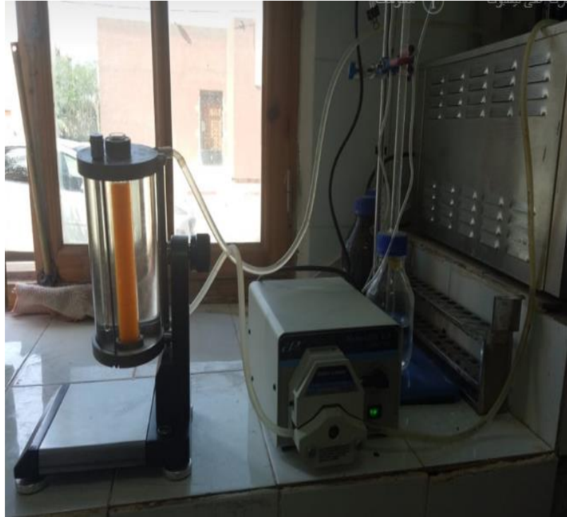
Photo 4-5: Détermination de la viscosité d'huile des noyaux de dattes.
