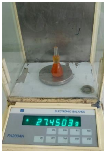
Photo 4-4: La mesure de densité par un pycnomètre.
