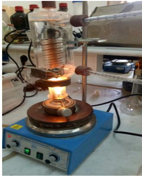
Photo 4-60 : Le montage de mesure de la pouvoir calorifique du biodiesel obtenu.
