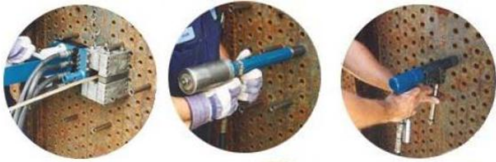
Figure 3.4 : Nettoyage à l'aide d'un pistolet hydraulique
