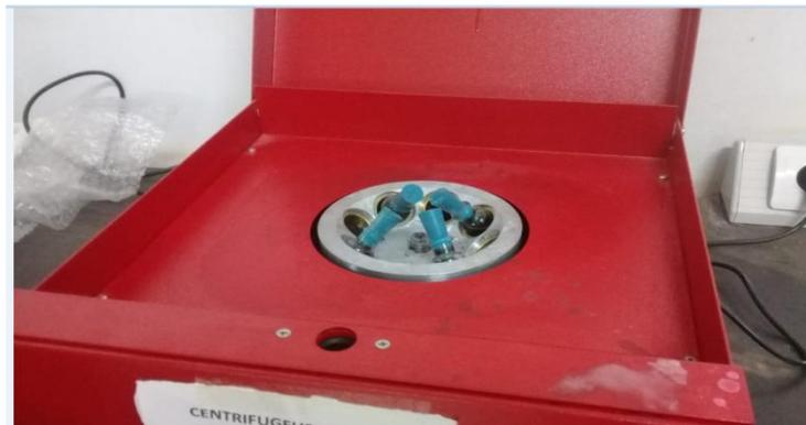
**Photo II.4 :** Centrifugeuse de Gerber.
