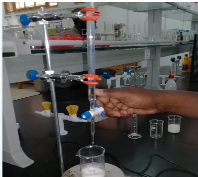
**Photo II.3** : Mesure d'acidité titrable en °D pour le lait reconstitué.
