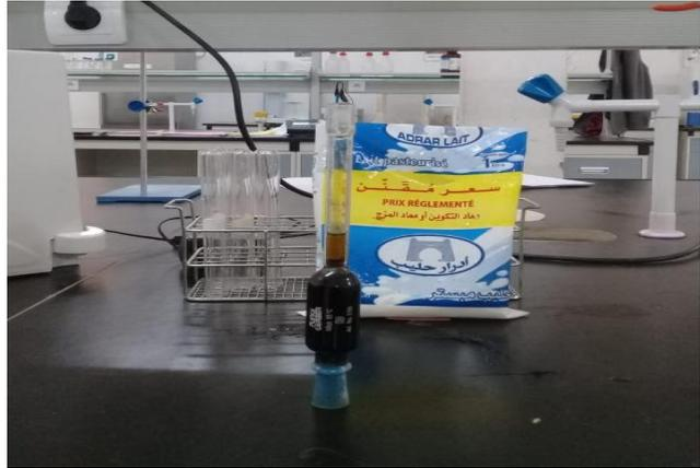
**Photo II.5 :** Mesure de la teneur en matière grasse à l'aide d'un butyromètre.
