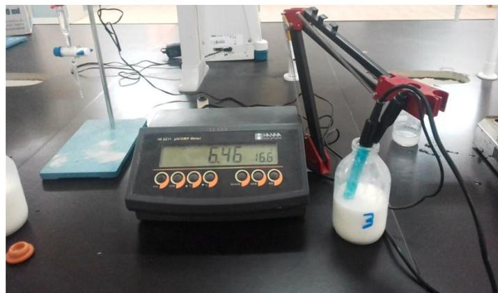
**Photo II.1** : Mesure du pH par un pH mètre.
