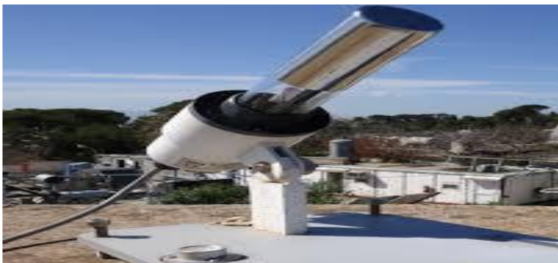
Figure 4.2 : Appareil de mesure de l'irradiation global Pyrhéliomètre.
