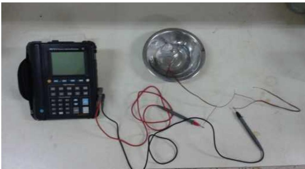
**Fig. III A.6 : Montage de thermocouple**
